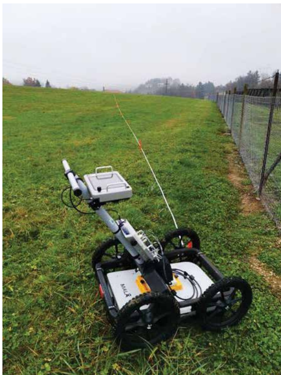
Slika: Georadarska oprema – terenski voziček s kontrolno enoto, anteno in monitorjem
