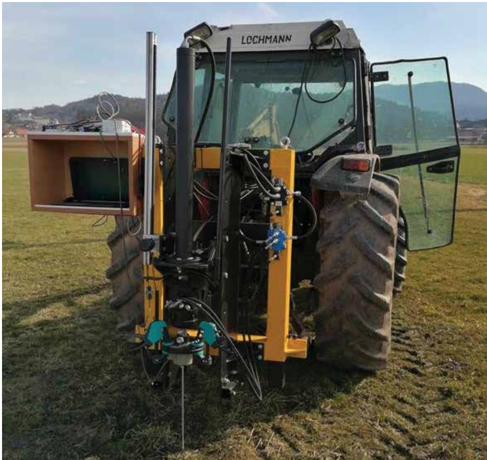
Slika: Ugotavljanje specifičnega odpora tal z metodo vertikalnega penetrometriranja
