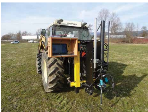
Slika: Mobilna naprava za ugotavljanje specifičnega upora tal in odvzem vzorcev tal, razvita na Kmetijskem inštitutu Slovenije
