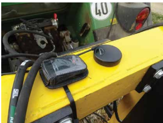
Slika: Dva GPS sprejemnika za določanje geolokacije za posamezni odvzem podvzorca tal in meritve specifičnega upora tal
