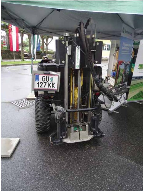
Slika: Naprava za odzemanje vzorcev tal Wintex na motornem štirikolesniku. Avstrijski strojni krožki s takimi napravami izvajajo storitve vzorčenja in analiz talnih vzorcev.
