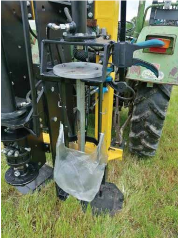
Slika: Detajl prikazuje sklop za hitro praznitev odvzetih vzorcev tal iz sonde za zajem neporušenih vzorcev tal v vrečko za odvzete vzorce tal.
