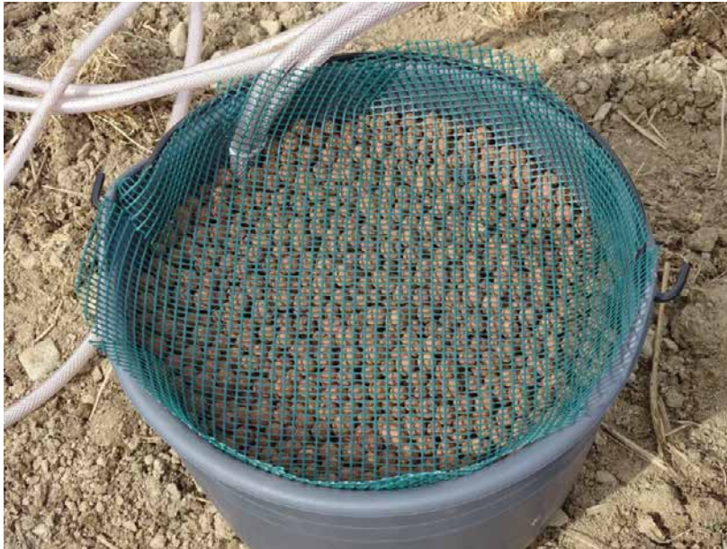
Slika: Izvedba malega lizimetra
